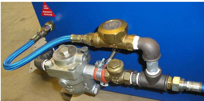
Abbildung 4-2 Zusammenbau der Komponenten des Montage Sets 8326 mit MFP (Art.nr. 130061)
